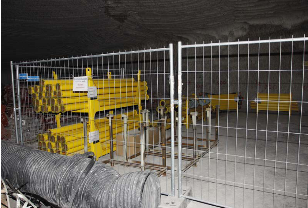
Abbildung F-6: Untertägiges Materiallager auf der 490-m-Sohle für den Notfall der Schachtanlage Asse II (Bildrechte: BfS)
