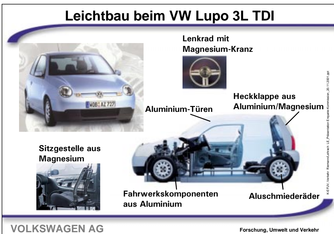
Abbildung 8: Innovativer Leichtbau beim Lupo 3L TDI
