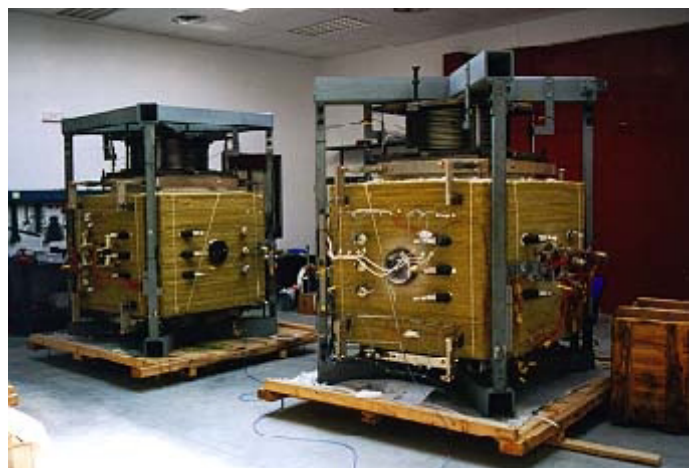
Abb. 5: Beispiele für technisch realisierte Brennstoffzellen-Stacks, hier von DeNora (links) und Ansaldo (rechts)
