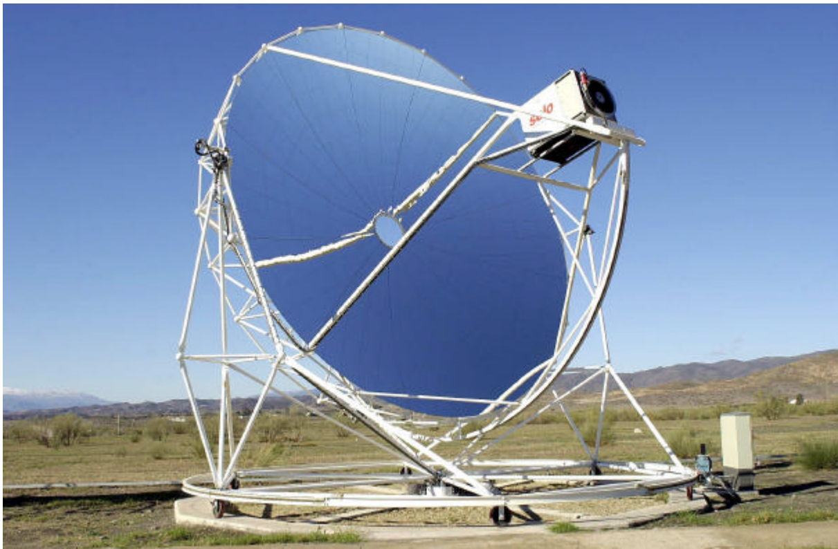
Abbildung 4–47: Eurodish System mit Stirling Generator
