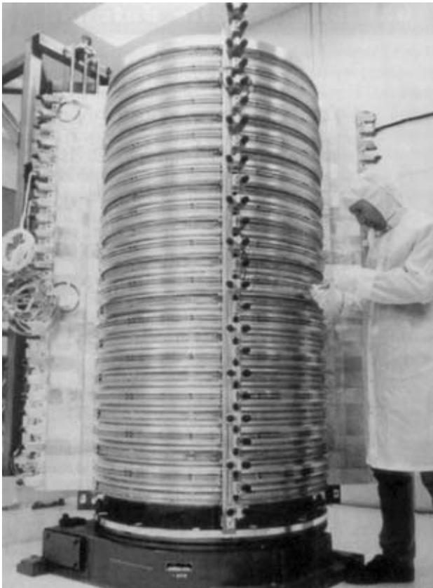
Quelle: nach INT 2002. Die auf dem Bild erkennbaren ringförmigen Module enthalten die Einspritzdüsen für das Treibstoffgemisch.
