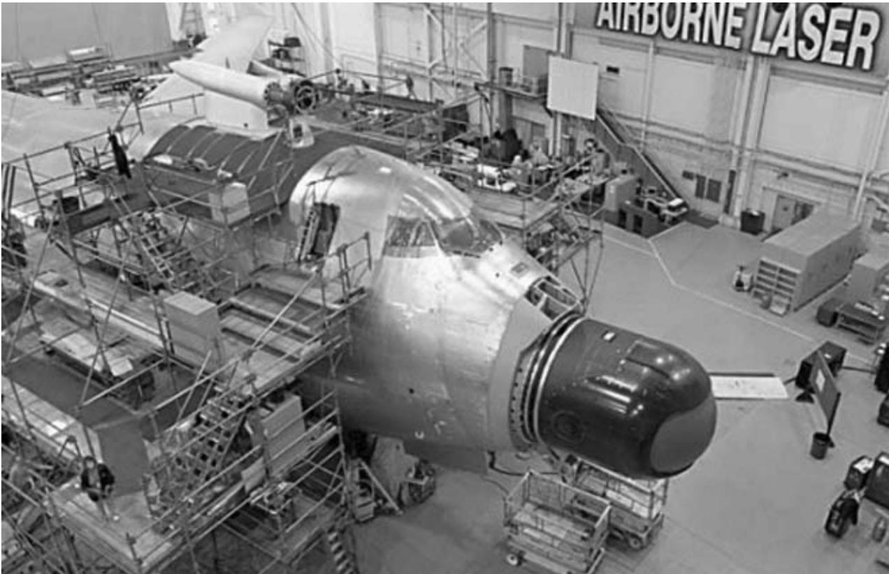
Die Flugzeugnase ist ein 1:1-Modell für die Flugtauglichkeitstests, die seit Juli 2002 begonnen haben. In der Nase wird später der bewegliche Hauptspiegel montiert (1,5 m Durchmesser), der den Haupt-, den Mess- und den Beleuchtungsstrahl auf das Ziel fokussiert, typischerweise quer zur Flugrichtung. Der Aufbau oberhalb der Pilotenkanzel enthält den Laserentfernungsmesser.
