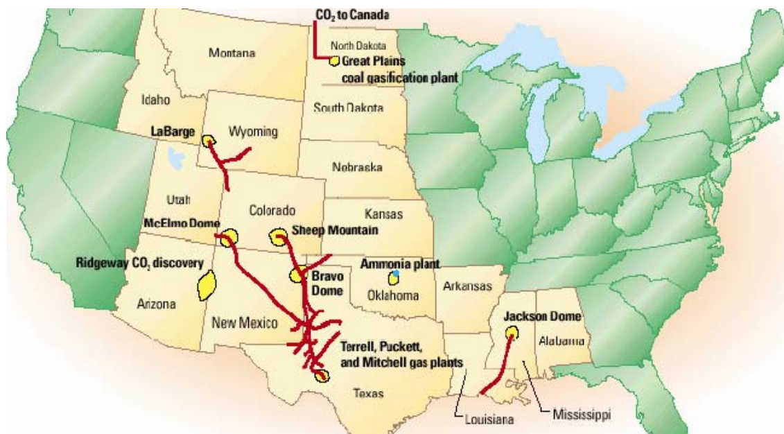
Abbildung 3: CO 2 -Pipelines zur verstärkten Ölförderung in den USA (Quelle: Boland 2005: 36).
