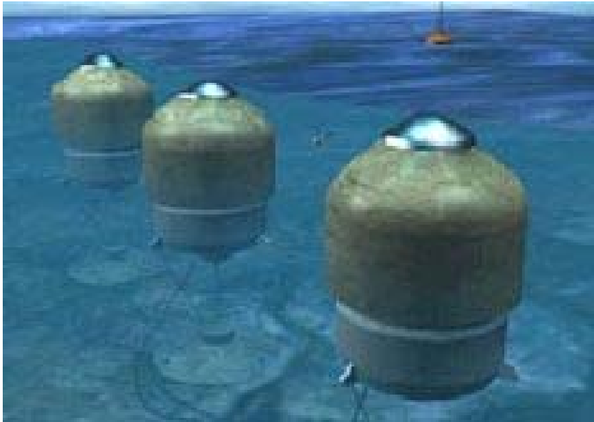
Abbildung 3: Alternatives Konzept der Energiegewinnung aus Wellen: Mehrere am Boden verankerte Schwimmkörper bewegen sich aufgrund der Wellen gegeneinander. Die Energie dieser Bewegung soll zur Stromerzeugung genutzt werden.
