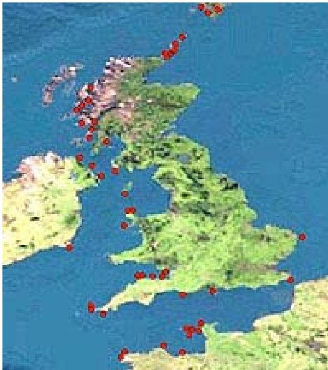
Abbildung 6: Einige geeignete Standorte für Strömungskraftwerke in Großbritannien und Frankreich. [Quelle: Marine Current Turbines Ltd.]
