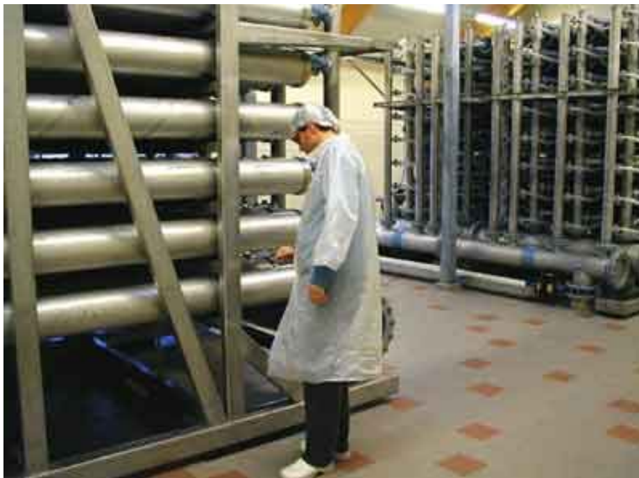
Abbildung 11: Um die notwendige große Membranfläche platzsparend unterzubringen, werden die Membranen aufgerollt und in Röhrenmodule eingebaut. [Foto: Statkraft]
