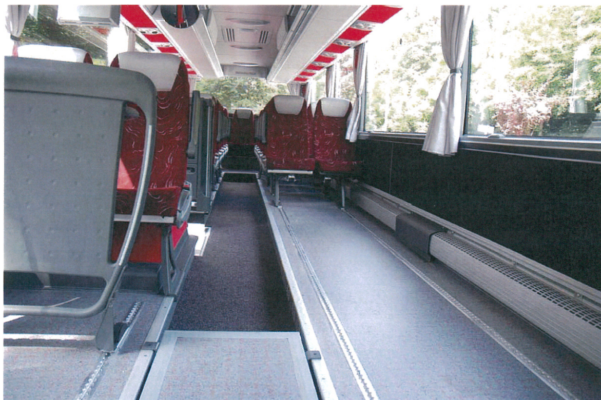
Nach Bedarf können Sitze für Rollstuhlplätze ausgebaut werden (erfordert Platzbuchung für RollstuhlnutzerInnen)
