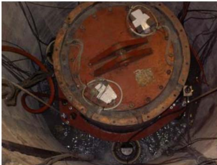
Abb. 4 Technische Demonstration der Rückholung eines KBS-3 Behälters aus einem Bohrloch (SKB, 2006)
