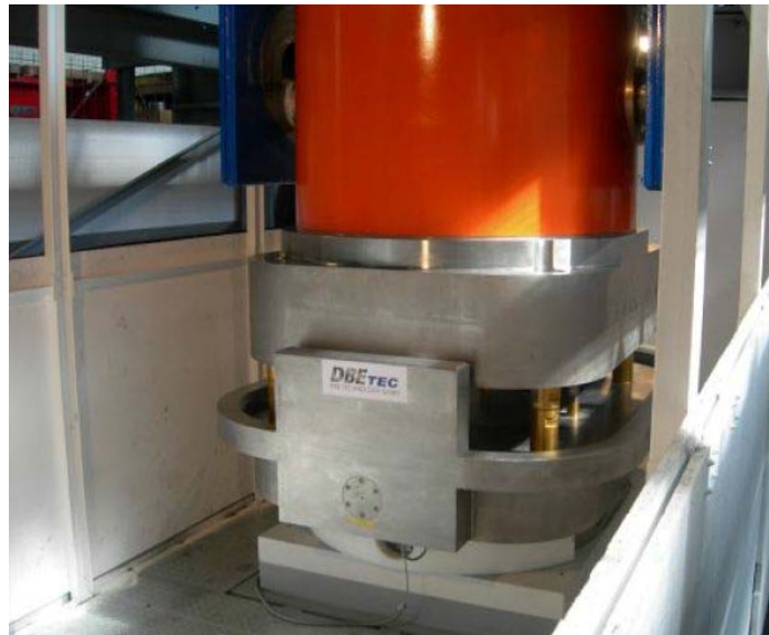
Abbildung 6-15: Einstellen des Transferbehälters auf die Bohrlochschleuse /GRS 11/
