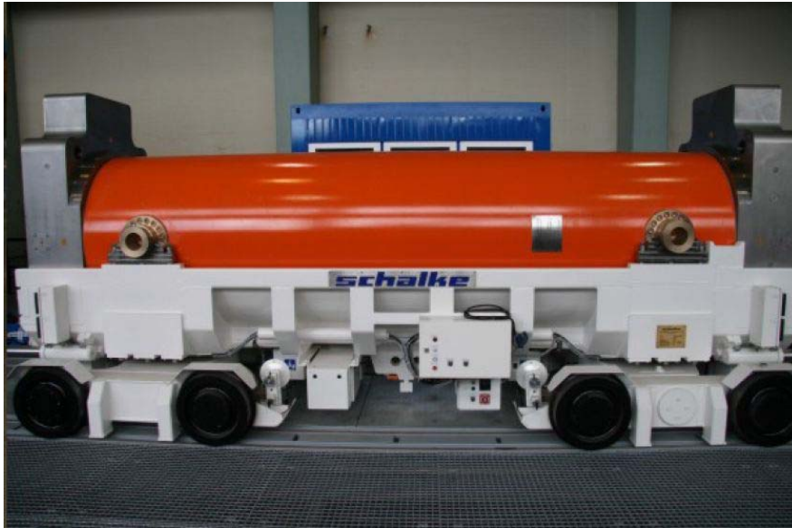
Abbildung 6-11: Mit dem Transferbehälter beladener Plateauwagen /GRS 11/
