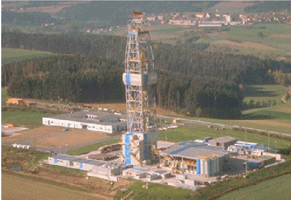
Figur 2-10. Borrrigg – UTB-1 GH 300 EG som användes i det kontinental djupborrningsprogrammet i Tyskland (Harrison 2000).
