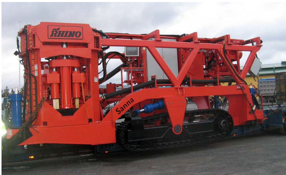
Figur 2-4. En prototypmaskin för borring av deponeringshål som testas just nu av Posiva. Foto: Posiva Oy.
