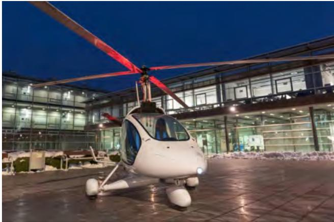
**Abb. 13:** Im Fraunhofer-Anwendungszentrum für multimodale und luftgestützte Sensorik des Fraunhofer-Instituts für Hochfrequenzphysik und Radartechnik FHR am RheinAhrCampus der Hochschule Koblenz wird auf Basis eines Tragschraubers eine fliegende Sensorplattform für Aufgaben in der Land- und Forstwirtschaft entwickelt.
