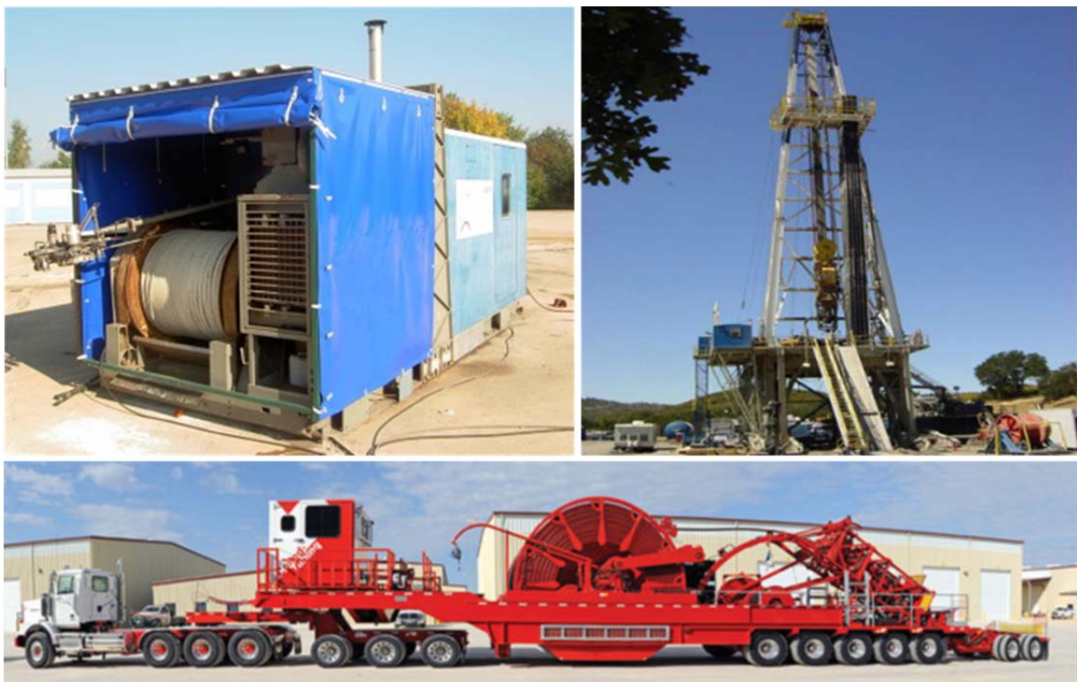
Abb. 7-10 Einbringungs- und Rückholungsverfahren mit Kabelwinde (links, oben), Coil Tubing Unit (mitte, unten) und Gestänge durch einen Bohrturm (rechts, oben)
