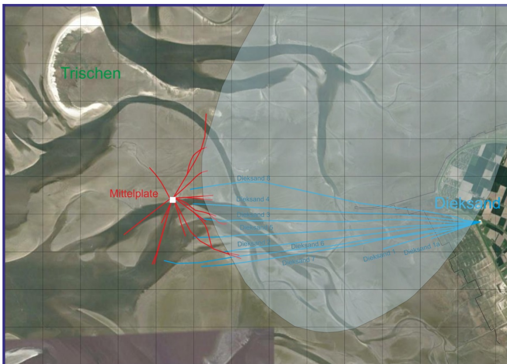
Abb. 6-9 Übersicht über den horizontalen Verlauf von Bohrungen von der Station Dieksand und von der Bohrplattform Mittelplate im Bereich der Öllagerstätte Mittelplate im Wattenmeer (Bild: Google). In hellblau ist der Salzstock Büsum eingezeichnet. Links oben im Bild ist die Vogelinself Trischen. Der Gridabstand ist 1.000 m. Der Horizontalverlauf der Bohrungen Mittelplate und Dieksand ist /FRA 03/ entnommen.
