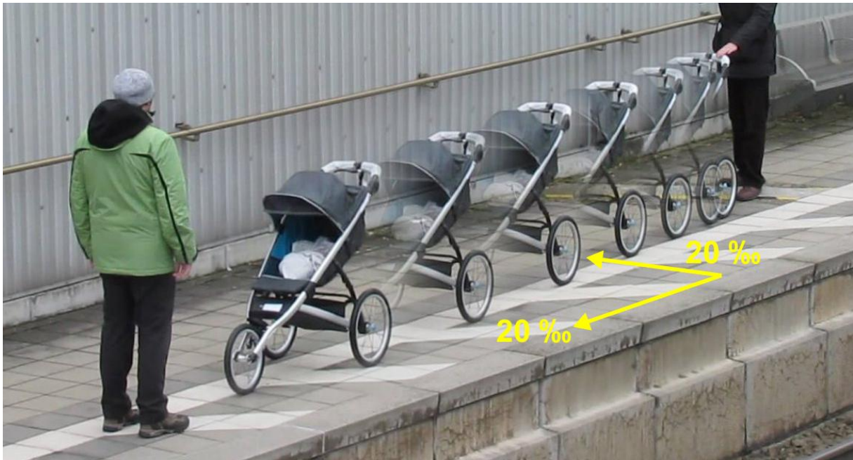
Abb. 11: Wegrollversuch mit einem Jogger-Kinderwagen in Ingolstadt Nord (überblendete Bilder in 2 Sek. Abstand des Videos auf drive.google.com ). Für flache Winkel zur Bahnsteigkante rollt der Kinderwagen trotz der von der Bahnsteigkante abfallenden Querneigung in die Gleise. Bei 20 ‰ (Promille) Längsgefälle näherte er sich in 12 Sekunden 60 cm der Bahnsteigkante. Ungebremst wäre er ins Gleis gestürzt, wie auch bei 15 ‰ und 10 ‰ Längsgefälle. Das Quergefälle von 20 ‰ bringt je nach Beladung in rund 14 % oder 1/7 der Fälle keine Sicherheit.
