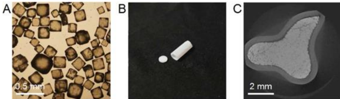
Abb. 3. Experimentelle Materialien. (A) Mikroskopische Abbildung (Auflicht) der Ausgangsalzkörner – kubische Einkristalle. (B) Teflonkapsel mit Aussendurchmesser 5 mm, die als Probencontainer genutzt wurde. (C) Ein Querschnitt durch die deformierte Probe im Innern der Teflonkapsel mit einer Auflösung von 8 \mu\text{m} (aus Ghanbarzadeh et al., 2015).
