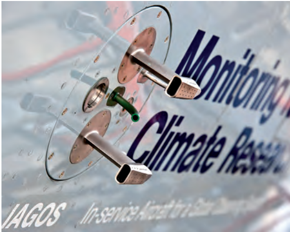
Einlassplatte am Lufthansa-Flugzeug für Messgeräte
