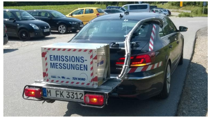
PEMS Messung am Fahrzeug ; Quelle: TÜV NORD, LUBW Bericht 2015
