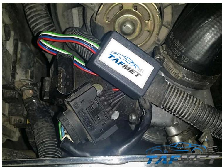
Abb. 12: Fertig montierter Simulator<sup>15</sup>
