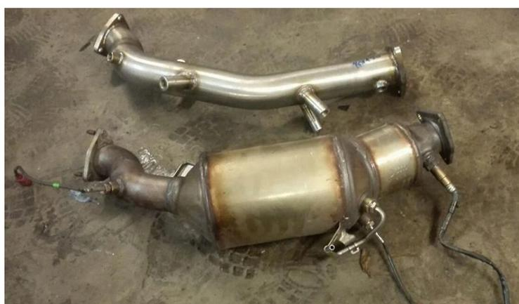
Abb. 18: Originalsystem und Downpipe<sup>19</sup>
