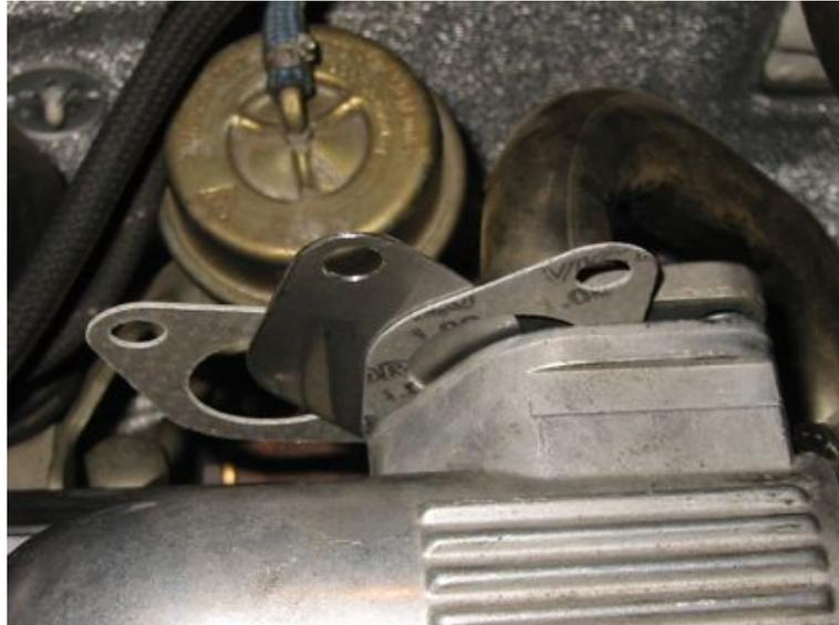
Abb. 13: Mechanische Blende (Blech) mit Dichtungen<sup>16</sup>
