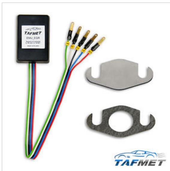
Abb. 11: Elektronisches Bauteil zur Verfälschung der AGR-Steller-Signale<sup>14</sup>
