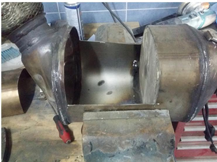
Abb. 19: Demontierter DPF-Monolith<sup>20</sup>
